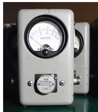
Vattmeeter – mõõteriist elektrivoolu võimsuse mõõtmiseks
