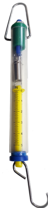
Dünamomeeter – mõõteriist, millega mõõdetakse kehale mõjuvat jõudu.
