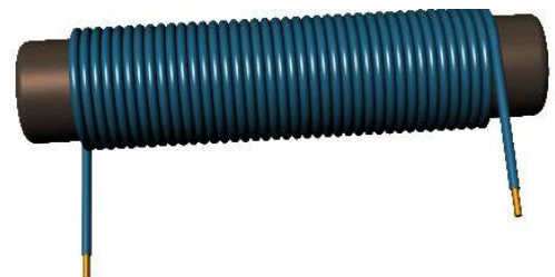
Lihtsaim elektromagnet on pool, mis koosneb juhtmekeerdudest ja raudsüdamikust.
