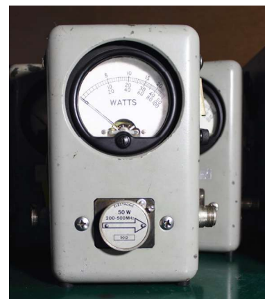
Vattmeeter – mõõteriist elektrivoolu võimsuse mõõtmiseks
