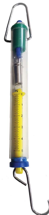
Dünamomeeter – mõõteriist, millega mõõdetakse kehale mõjuvat jõudu.
