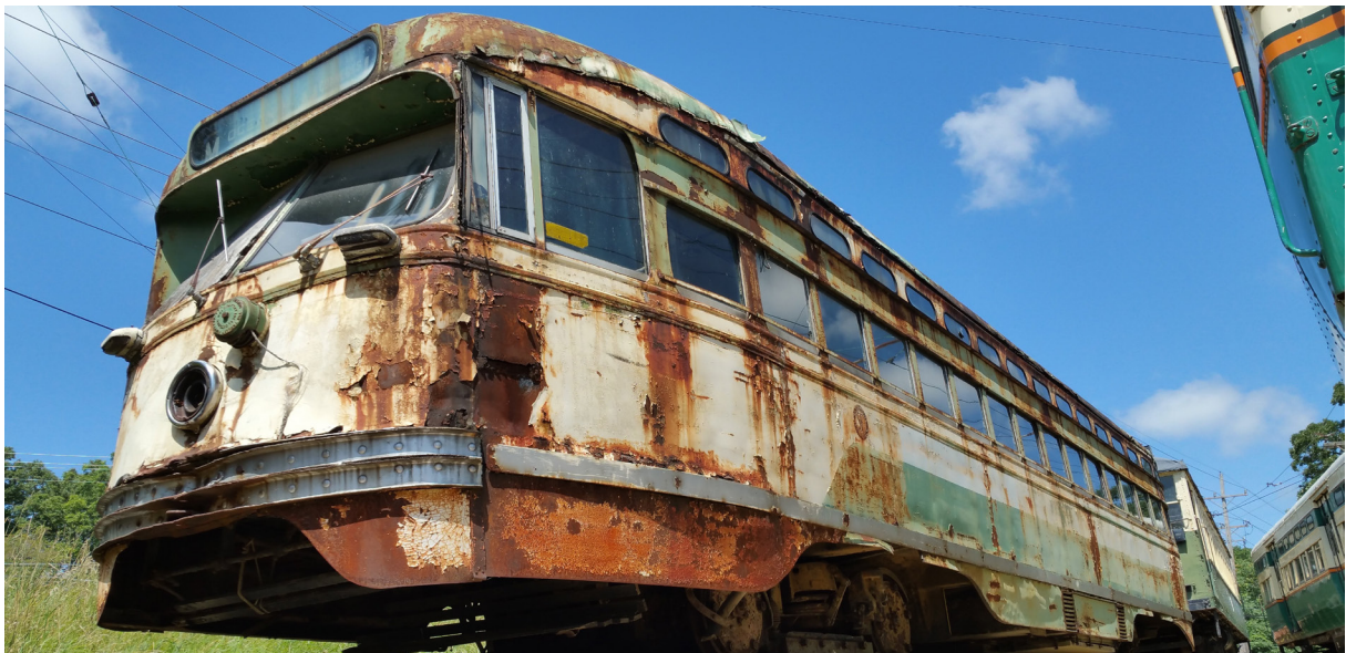
Raud roostetab hapnikuga kokku puutudes.
