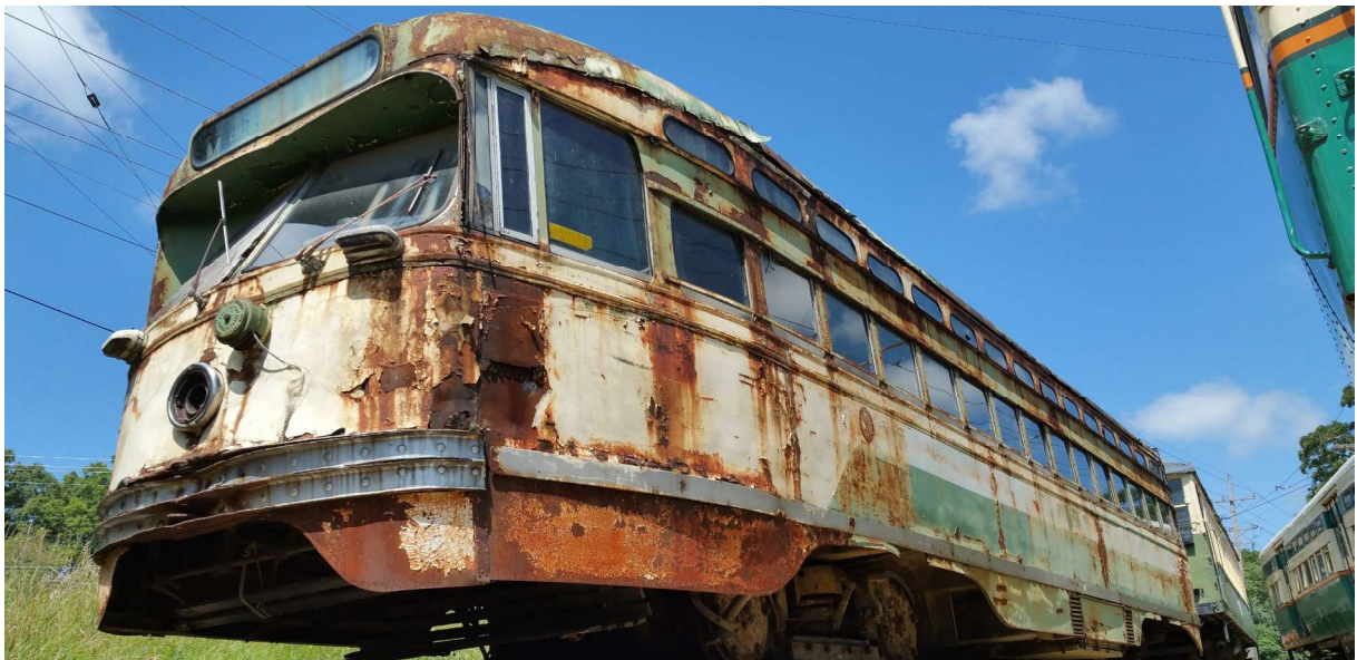
Raud roostetab hapnikuga kokku puutudes.
